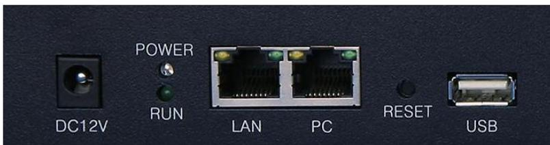
LAN 口使用 RJ-45 接口，用来连接局域网或者因特网。根据不同的网络，它可以连接到路由器、交换机、xDSL 调制解调器等等。该接口的默认设置是 DHCP 模式，即自动获取 IP。
