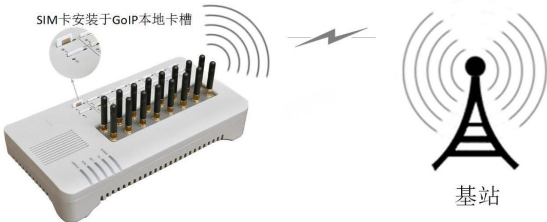
假设，把 GoIP 中的 SIM 卡取出，通过长导线连接到卡槽。那么无论导线有多长，无论 SIM 卡放置于何处，都相当于 SIM 卡直接插在 GoIP 的卡槽中。如下图：
