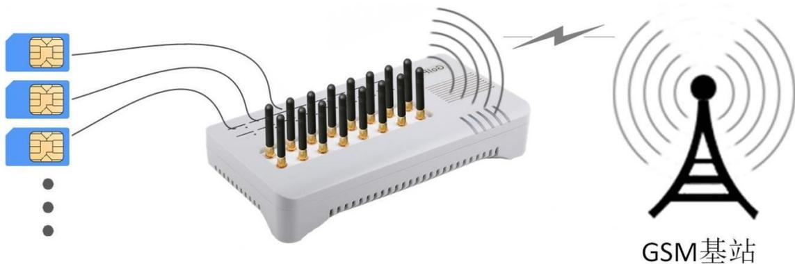
上述假设中，SIM 卡数据是通过物理导线来传输的。如果通过某个设备读取 SIM 卡数据，并通过网络连接传输到 GoIP 呢？这就是 SMB 的作用了。如下图：
